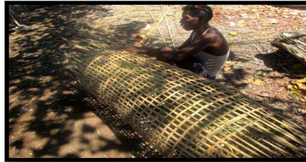
Gambar 7. Proses pembuatan perut dan badan bubu.
