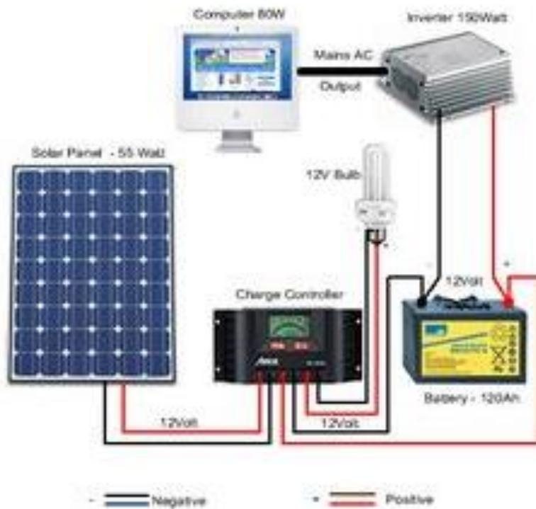
Gambar 1. Skema sistem *off-grid* 12 volt listrik tenaga surya
